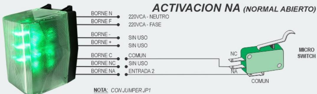
Para el uso de **Barreras Infrarrojas**, modelo **BI015**, también se podrá utilizar 1 (uno) o 2 (dos) y además se podrá optar por el tipo de contacto (NA ó NC), debiendo configurar el semáforo de la misma manera.
