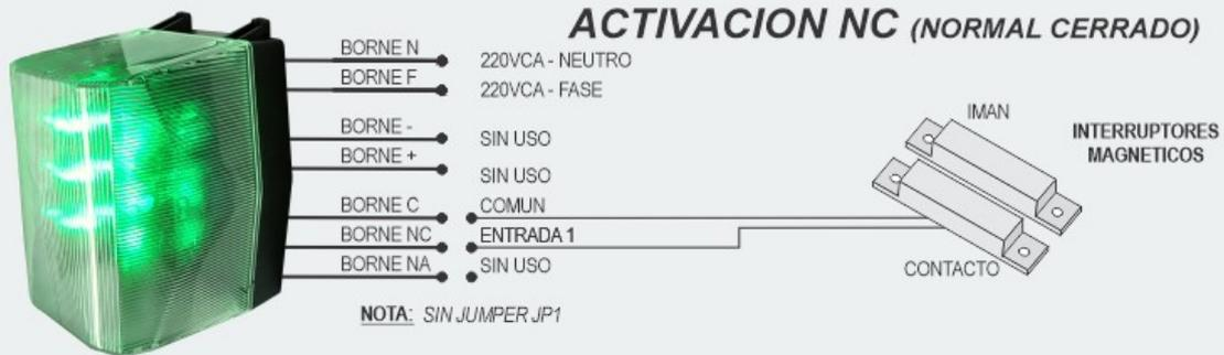
En el caso de un micro-switch o fin de carrera, también se podrá utilizar 1 (uno) o 2 (dos) y además se podrá optar por el tipo de contacto (NA ó NC), debiendo configurar el semáforo de la misma manera.
